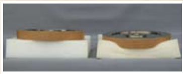
硬度比較 左：「シャープフロー」使用 右：従来品使用
