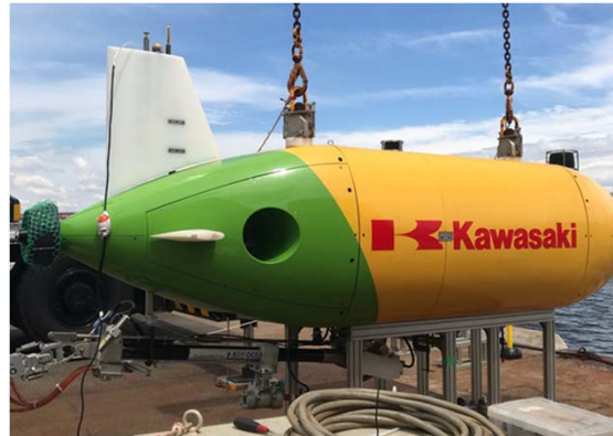
使用される全樹脂電池（ケース外観） 川崎重工業（株）製AUV外観
